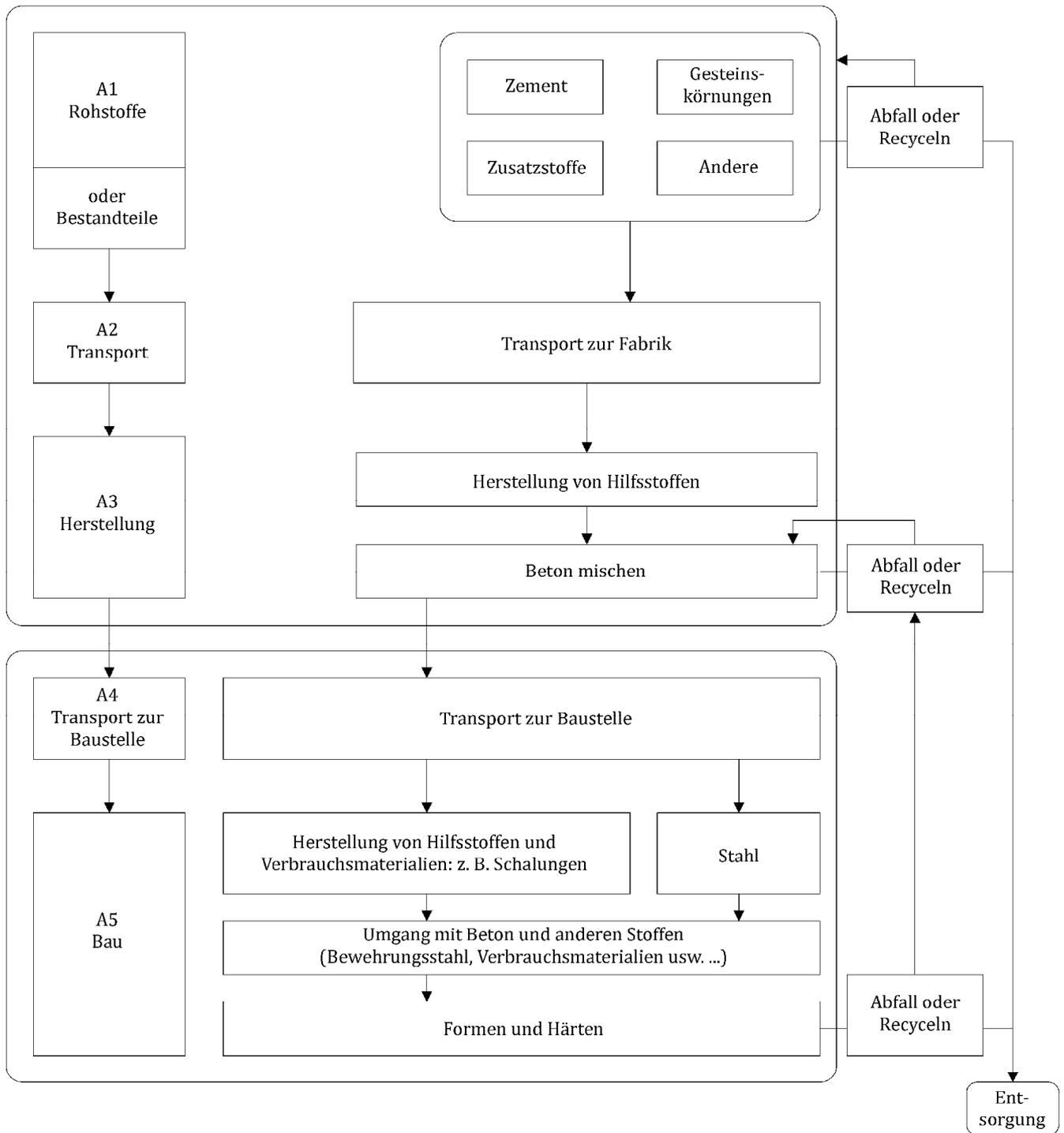
**Abbildung 1: Systemgrenzen A1 - A5 für Transport und Baustellenbeton [9]**
