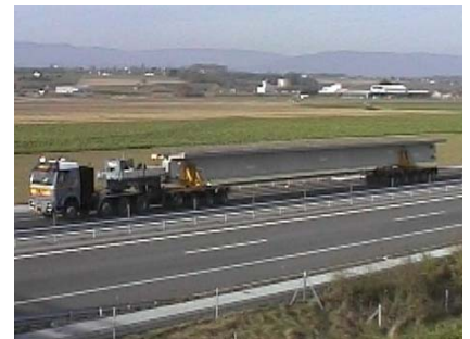
Transport spécial des poutres à 74 to
