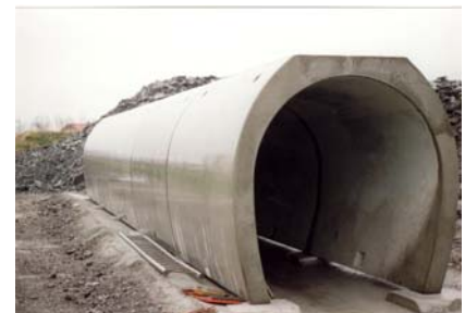
Montage d'essai à l'usine
