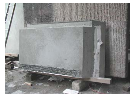
Panneaux sandwich finis avec armure de raccordement
