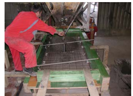
1. Remplissage de la couche de parement
