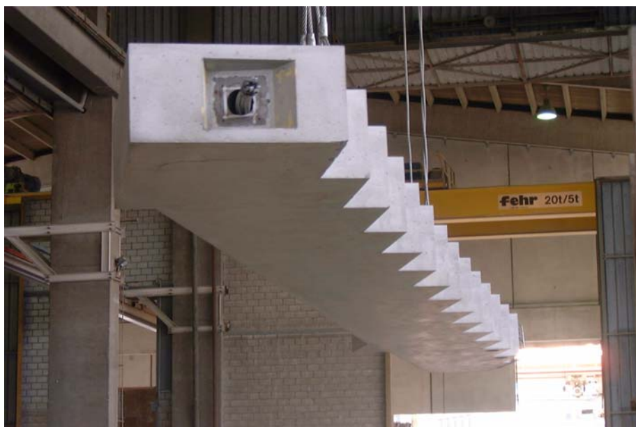
Der Sägerträger ist ausgeschalt
