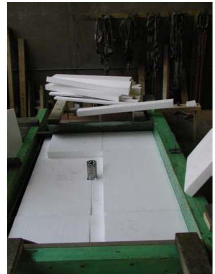
Doppelte Wärmedämmschicht mit Manschettenanker in der Plattenmitte
